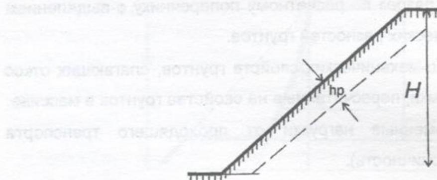
Рис 2. Общая схема к расчету местной устойчивости откосов горных дорог на склоне
